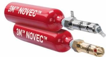
Durch die steigende Temperatur im Schaltschrank bei einem Feuer bildet sich in der Thermoampulle ein Überdruck. Nach dem Erreichen einer definierten Temperatur platzt die Ampulle und löst dadurch einen Federmechanismus aus, der den Zylinder öffnet. Das Löschmittel strömt aus und löscht den Entstehungsbrand in wenigen Sekunden.
